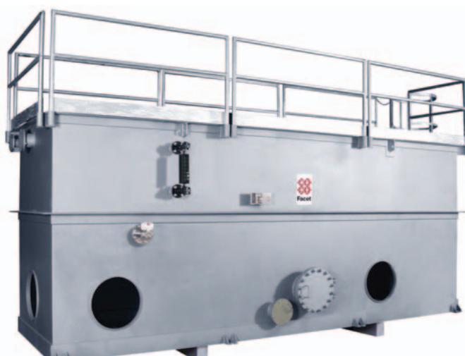
Серия MAS, пластинчатые коагуляционные сепараторы воды и нефти Facet предназначены для обработки углеводородной воды. Данные сепараторы можно загружать под действием силы тяжести или под давлением. Сепарация выполняется физическим способом, не требует расходных материалов и не имеет движущихся частей, ввиду чего нет необходимости в обслуживании, и не бывает сбоев в работе. Внутри сепараторов установлены коагуляционные пластины двойного гофрирования FACET MPak®.
